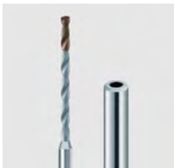
刃径 \phi 0.8mm \sim \phi 3mm、5xD \sim 20xDの油穴付き超硬ドリル ( \phi 1.45以下にブースト給油機構採用)
